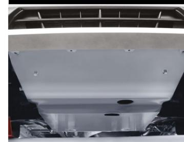
Motor- und Getriebeschutz
