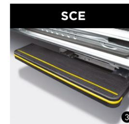
Seitliche Heavy-Duty elektrische Schwenk-Trittsstufe
