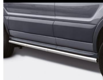
Seitenschwellerschutzrohre aus Edelstahl
