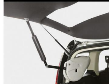
Elektrischer Antrieb für Heckklappe
