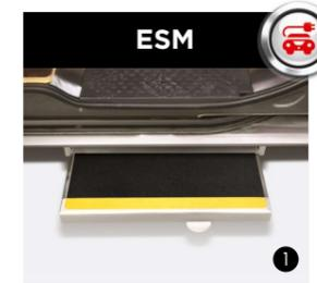
Seitliche manuelle Kassettenstufe
