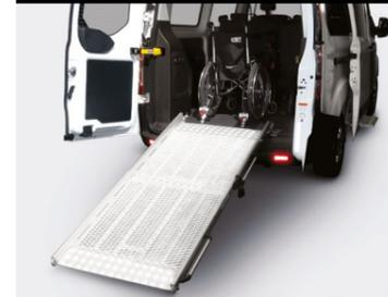
Festmontierte Rollstuhlrampe für Kleinbusse
