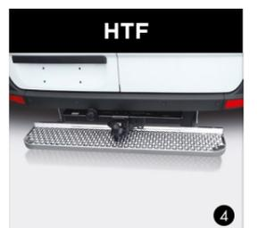
Hecktrittstufe aus Stahl feuerverzinkt, mittig
